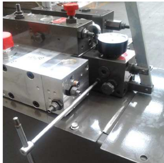
Fig. 17 – Impianti con valvola HDU integrata
